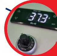
Réglages température tuyau et enceinte chauffante
